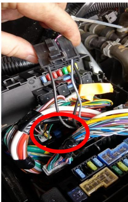
Abbildung 7: Anbindung Heizung / Position Stecker
