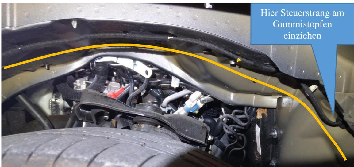
3. Ziehen Sie das Hauptkabel entlang der Träger und bestehenden Kabelstränge zunächst nach hinten, dann entlang des Querträgers hinter dem Reserverad bis in das Rückleuchten Gehäuse hinein. Fixieren Sie alles und kommen Sie mit keinen beweglichen Teilen in Kontakt!
